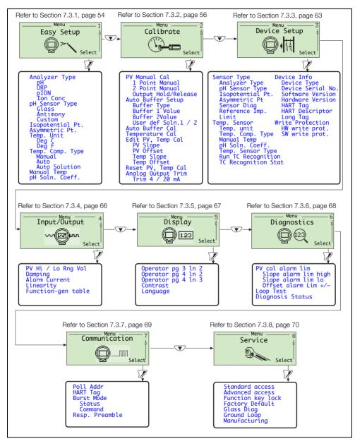
Fig. 7.3 pH Parameters
