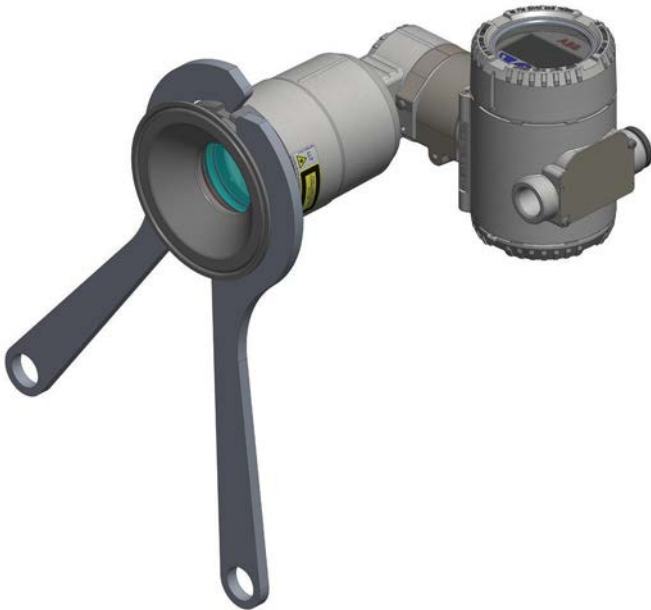
Figura 30 Desmontar o flange com chaves de boca
