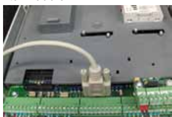
Anslut strömriktaren (X34) till PC:ns COM-port
