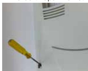
Ta bort DCS800-manöverpanelen om sådan finns. Tryck ner spärrknapparna för att ta av kåpan
